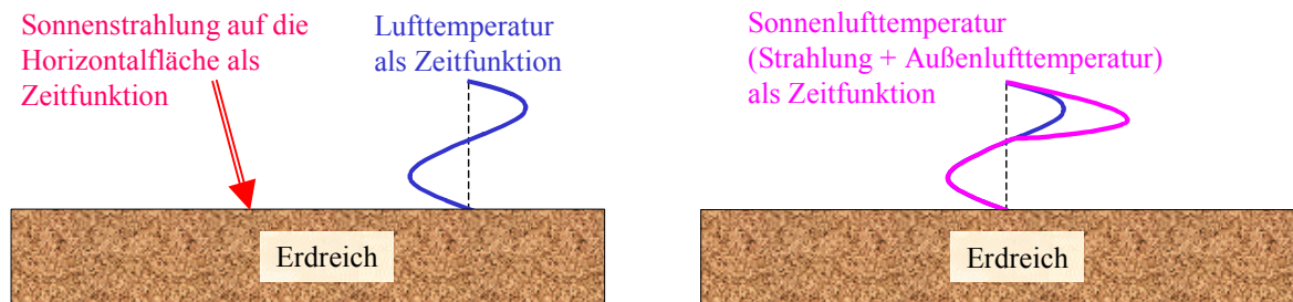
Bild 5.2 Prinzipdarstellung der Superposition der Lufttemperatur und der Gesamtsonnenstrahlung zur Sonnenlufttemperatur (Links: Reale Einzelwirkungen; rechts: Superposition)
