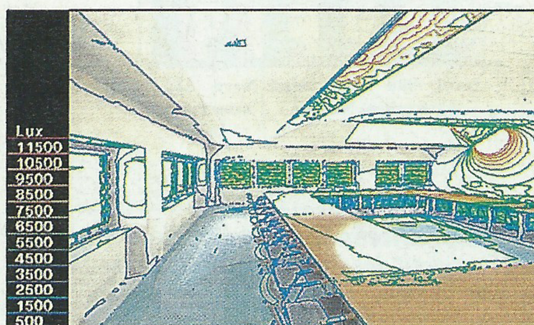
Bild 2: Ergebnisse der tageslichttechnischen Simulation für einen Konferenzraum mit optimal verteilten Oberlichtern in fotorealistischer Darstellung mit Linien gleicher Beleuchtungsstärke.
