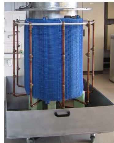
Bild 23 oben: Hydraulische Verknüpfung zwischen einem Kühlturm und einem Speicher
