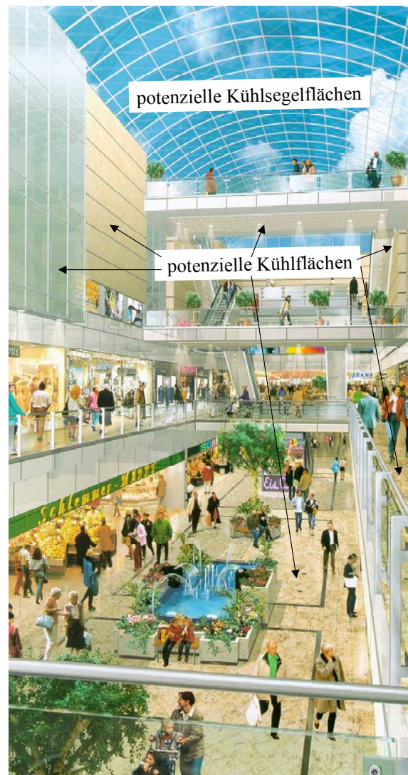
Bild 15.1 Blick in das untersuchte Einkaufszentrum mit Kennzeichnung möglicher Kühlflächen im Bereich der Verkaufsstraße
